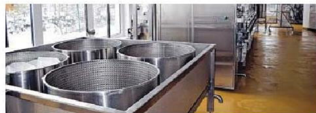
Hightech in der Käseküche: Vieles läuft heute vollautomatisch ab in der Sennerei in Gunzesried. Es gibt nicht mehr vier kleine, sondern einen großen Kupferkessel zum Käsemachen. Automatisch läuft die Käsemasse von dort in Formen aus Edelstahl oder Kunststoff. Im Vordergrund steht die Emmentalerpresse. Fotos (2): C. Conradi
