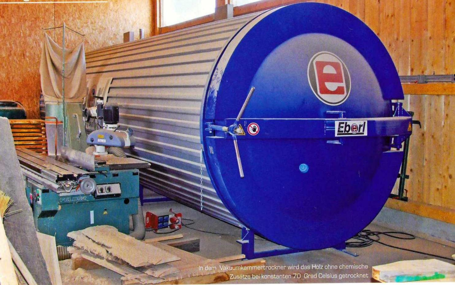
In dem Vakuumkammertrockner wird das Holz ohne chemische Zusätze bei konstanten 70 Grad Celsius getrocknet
